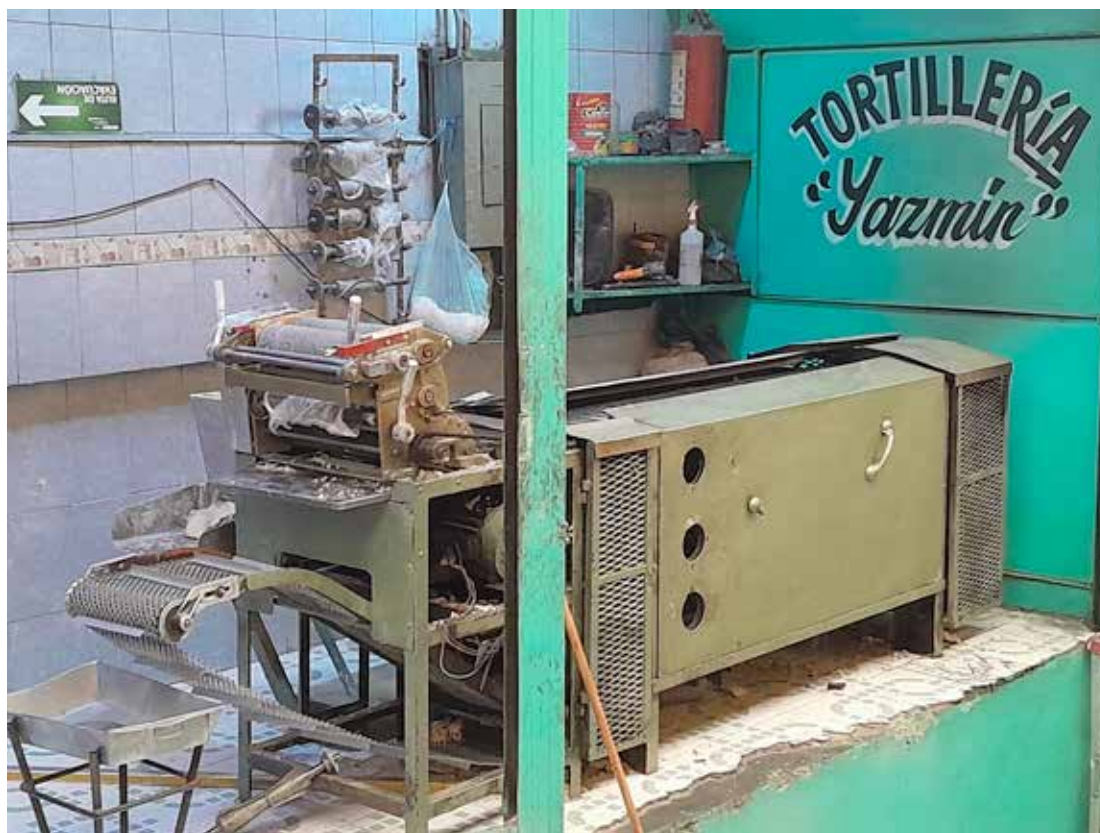
Izq y arrib.: Máquinas tortilleras . Son varios los tipos de máquina que existen, pero en su mayoría poseen un sistema similar con un depósito para la masa que se aplana, rodillos que cortan la tortilla y una banda móvil para cocerlas.
